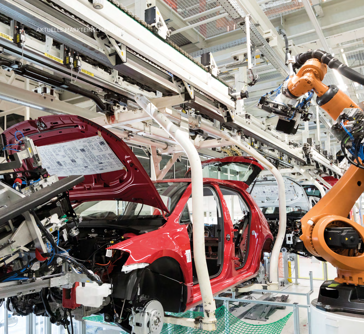
Vollautomatische Montage der Unterbodenverkleidung des VW Autos Golf 7 in Wolfsburg/Deutschland.
